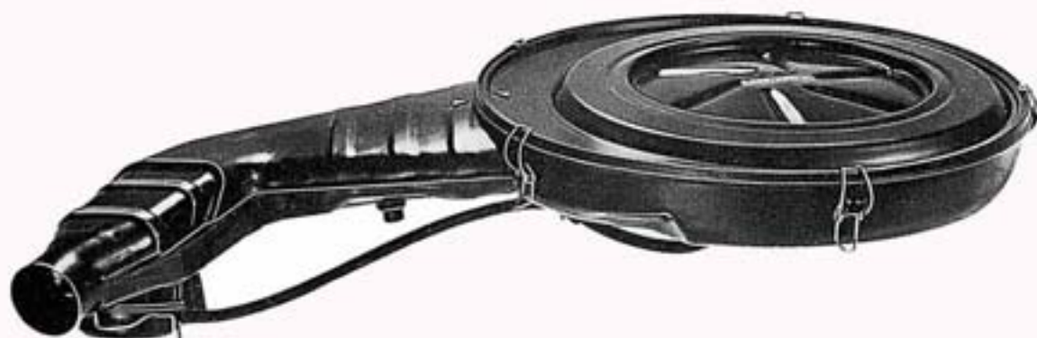
Luftfilter mit temperaturabhängiger Steuerung der Ansaugluft
